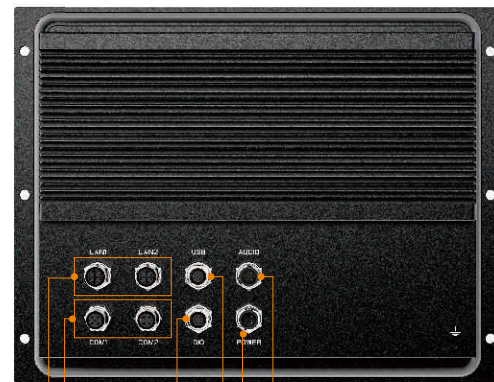
A B C D E F A: LAN1/2 B: COM1/2 C: DIO D: USB E: Power F: Audio
